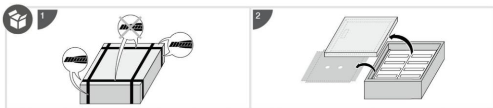
Durchdachte Verpackung des Feldverteilers FWU: vollflächiger Putzschutz, separate Verpackung von Blendrahmen und Tür für geschützte Zwischenlagerung
